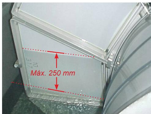
*Figura 5.2.1 Presión diferencial máxima permitida en funcionamiento continuo*
