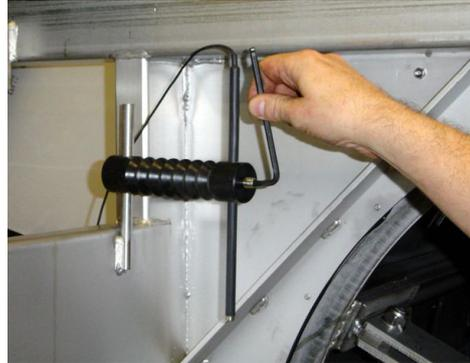
*Figura 5.2.2 Ajuste del sensor de nivel*
