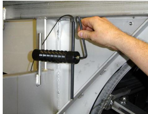
Figure 5.5.2 Réglage de la sonde de niveau
