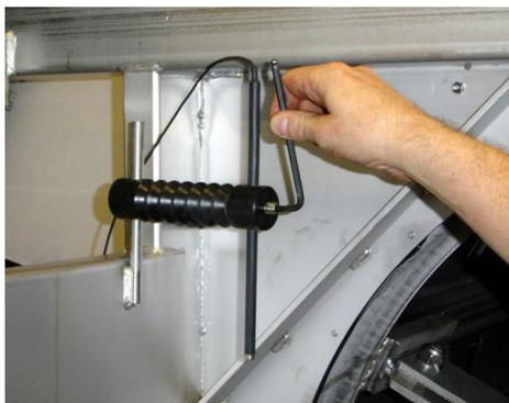
*Figura 5.5.2 Regolazione del sensore di livello*
