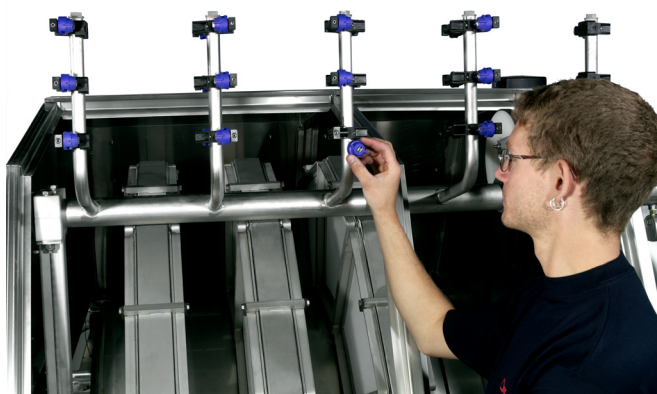
Figur 7.1.1 Spolrampen lyfts och en dysa tas bort
