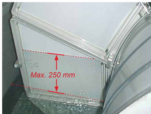
Figur 5.2.1 Maximalt tillåtet differenstryck vid kontinuerlig drift
