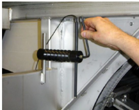
Figur 6.4 Justering av nivågivare
