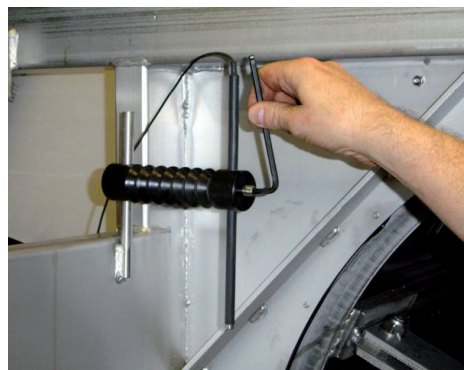
Figura 5.2.3 Ajuste del sensor de nivel
