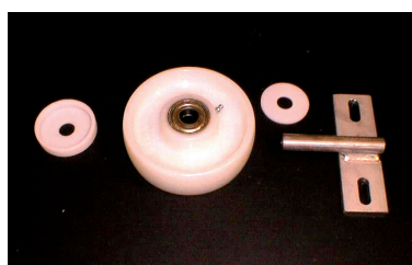
Figura 7.2.1c Componentes de la unidad de ruedas de apoyo.
