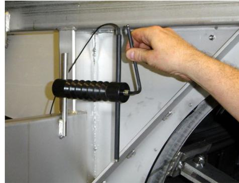
*Fig. 5.5.3 Réglage de la sonde de niveau*
