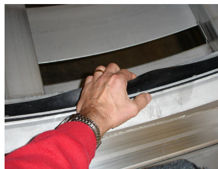
Рисунок 7.6 Резиновое уплотнение на впуске
