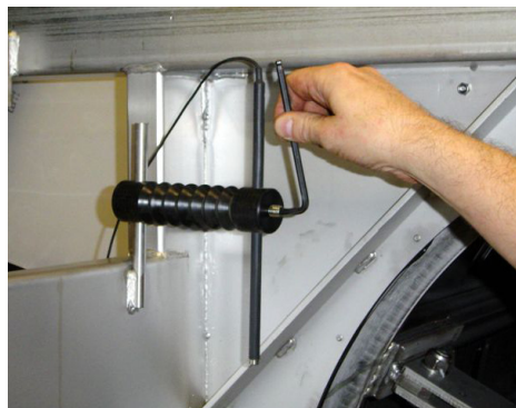
Рисунок 5.2.2 Регулировка датчика уровня
