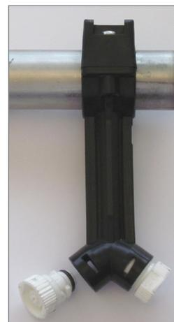
**Figure 7.9** Buses de la rampe de produits chimiques.
