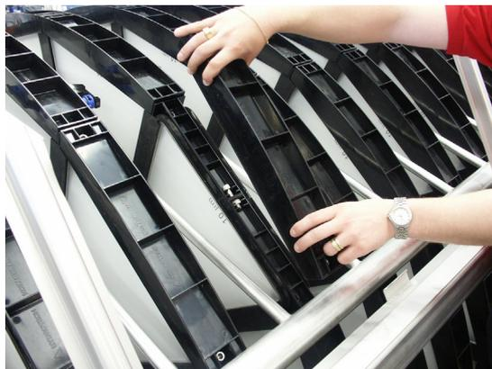
**Figure 7.11** Dépose du couvercle du segment de filtre.
