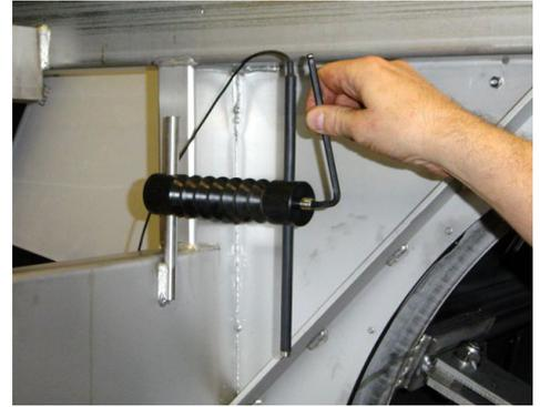
Figure 5.4 Réglage de la sonde de niveau.
