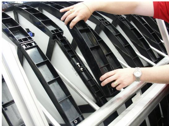
**Figure 7.12** Dépose du couvercle du segment de filtre.
