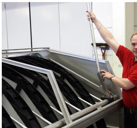
*Figure 7.2 a Placez le levier mobile dans la fixation.*
