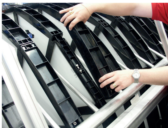
Figura 7.11 Rimozione del blocco dei pannelli del filtro.
