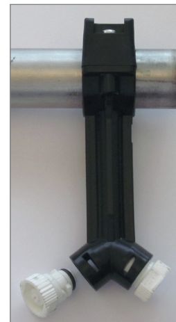
Figura 7.9 Ugelli di lavaggio della rampa per sostanze chimiche.
