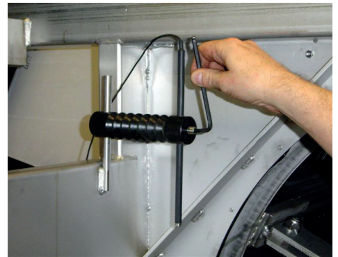
Figura 5.4 Regolazione del sensore di livello.
