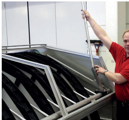
Figura 7.2 a Inserire la leva nell'attacco.
