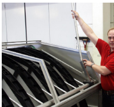
Figur 7.2 a) Placera den lösa hävarmen i fästet.
