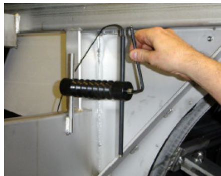
Figur 5.4 Justering av nivågivare.
