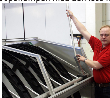
Figur 7.2 a) Placera den lösa hävarmen i fästet.
