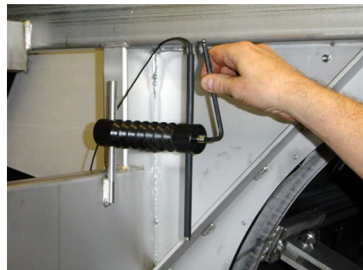
Figur 4.4 Justering av nivågivare
