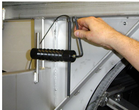
Bild 5.2.3 Justering av nivågivaren
