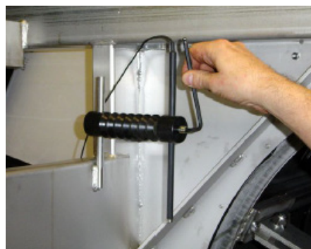
Figur 5.4 Justering av nivågivare.
