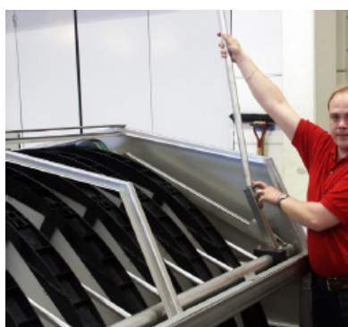
Figur 7.2 a) Placera den lösa hävarmen i fästet.
