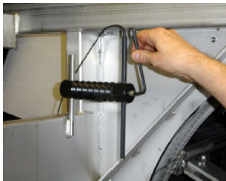
Figur 5.4 Justering av nivågivare.
